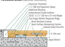
$\textbf{Slab Depression:}\ 25/32\text{''}\ (20\ \text{mm})\ flooring}\ -2\text{''}/\text{s"}\ (54\ \text{mm})\ \bullet\ 33/32\text{''}\ (26\ \text{mm})\ flooring}\ -2\text{''}/\text{s"}\ (60\ \text{mm})$
